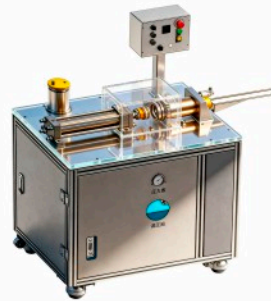
笔芯挤出机 Pencil core extruder
