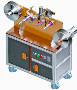
标签回卷机 Label rewinder
